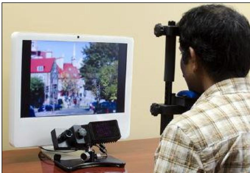
**Figura 3.1:** Esquema sistema *Eye-Tracker*, modelo EyeLink 1000. Fuente: SR Research
