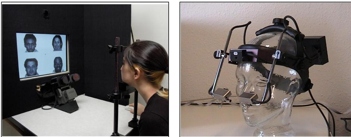
**Figura 2.3:** A la izquierda se ubica el EyeLink 1000 y a la derecha el EyeLink I. Se puede ver que el modelo I tiene la ventaja de tener las cámaras más cerca de la pupila pero no permite utilizar *Eye-Tracker* y electro encefalograma (EEG). Ambos modelos tienen el desempeño suficiente para ser usados en contexto de investigación.
