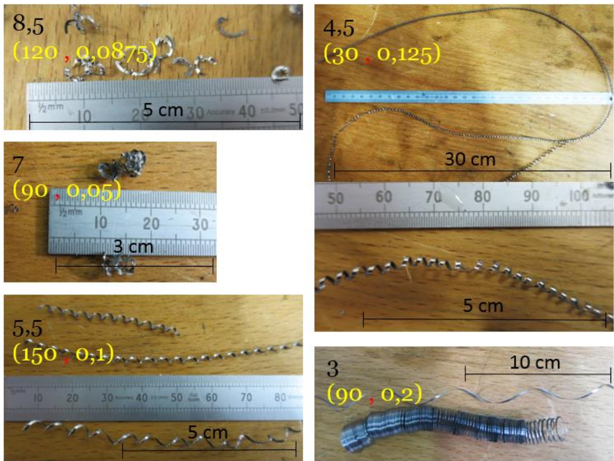
Figura 5.16: Imágenes de las virutas en material 300M.
