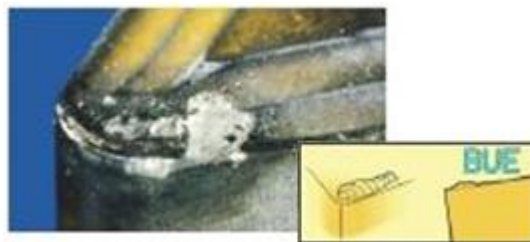
Figura 2.2: BUE (Built up Edge). En el inserto se deposita parte del material cortado [10].
