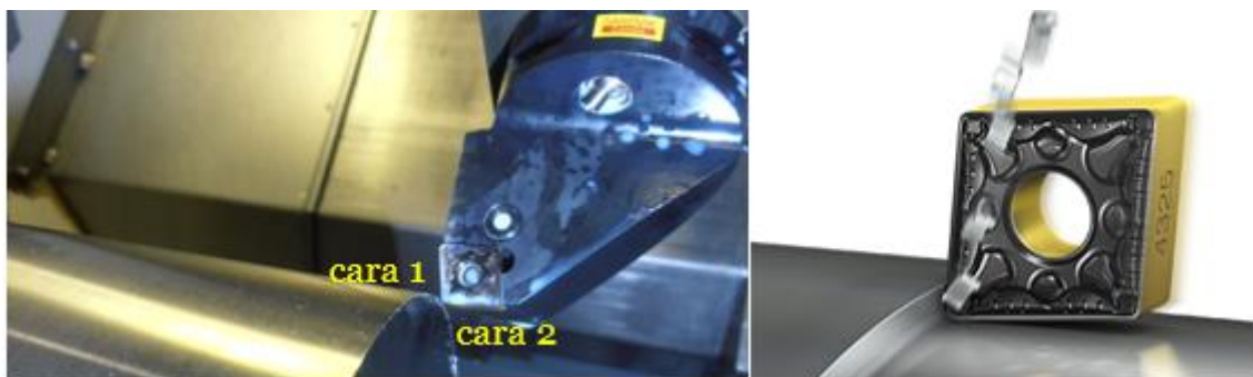
Figura 5.5: Caras del inserto en el corte.
