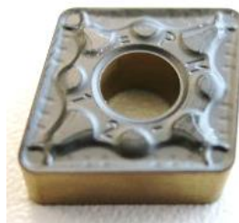
Figura 4.5: Inserto utilizado en los tres materiales para el desbaste.
