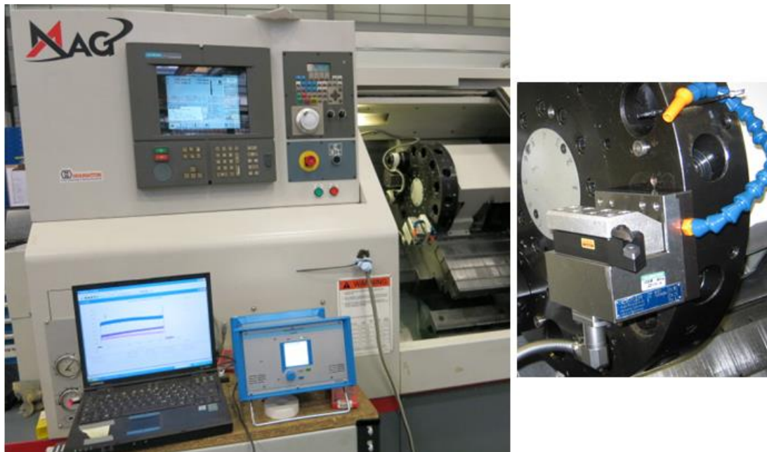
Figura 3.6: Set de medición de fuerzas Kistler 921, con su respectivo software, amplificador y dinamómetro.
