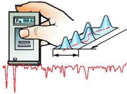
Figura 2.8: Forma de medir la rugosidad [14].
