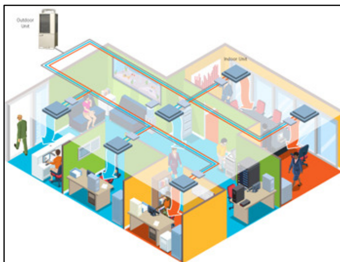
Imagen 7- VRF dentro de un edificio. Fuente: http://www.johnsoncontrols.com/
