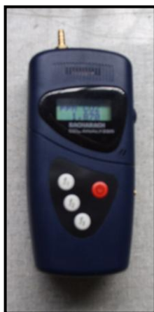
FIGURA 14. Analizador de CO 2 . Este instrumento detecta la presencia de CO 2 mediante el principio de radiación infrarroja. Mide concentraciones desde 0 a 10.000 partes por millón.
