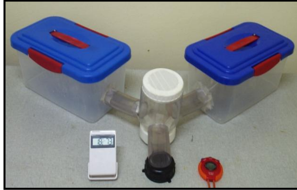
FIGURA 11. Dispositivo construido para el objetivo específico 1. Consistió de un recipiente central al que se conectaron tres tubos equidistantes entre sí, dos de ellos terminaron en un recipiente y el tercero se aisló del exterior mediante una malla. En el recipiente central se ubicó al insecto y en los recipientes externos los mamíferos.
