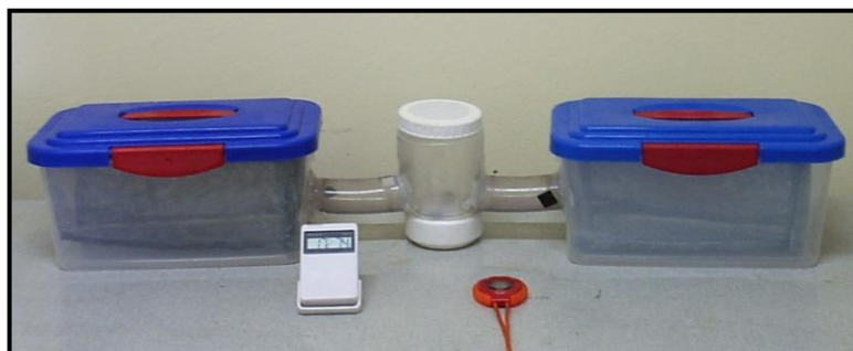
FIGURA 15. Dispositivo construido para el objetivo específico 3. Consistió de un recipiente central al que se conectaron dos tubos equidistantes entre si, cada uno de ellos terminó en un recipiente de plástico. Cada receptáculo lateral estuvo provisto de sales de cloruro de calcio (absorbente de humedad).
