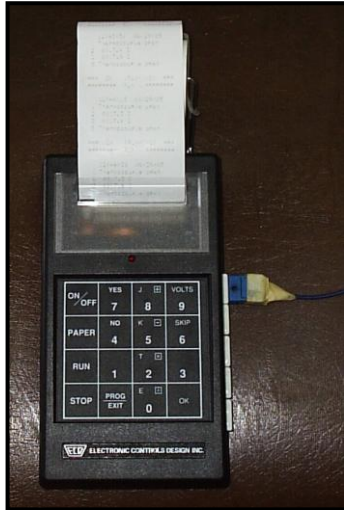
FIGURA 12. Datalogger. Instrumento que registra datos de temperatura mediante termocuplas (alambres de cobre que detectan temperatura)
