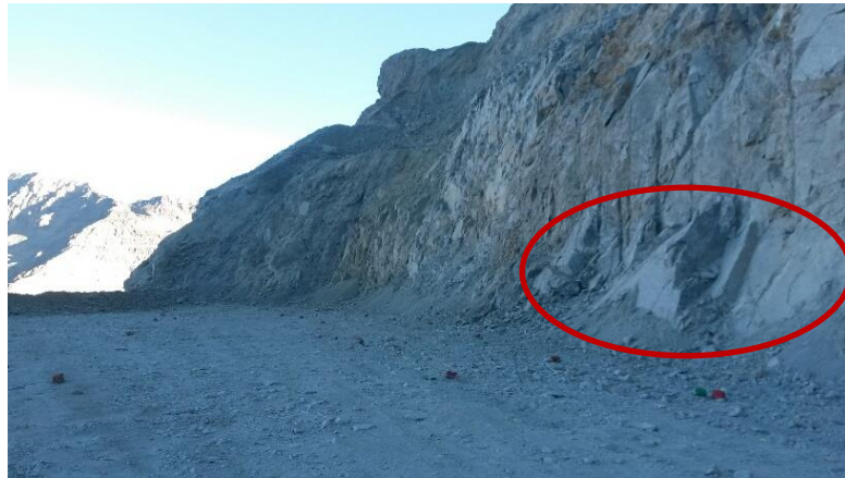
Ilustración 22: Material sin fragmentar en la pata del banco
