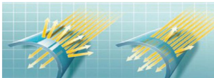
Figura 5. 28 Presentación sistemas con cubierta selectiva y sin ella. [102]
