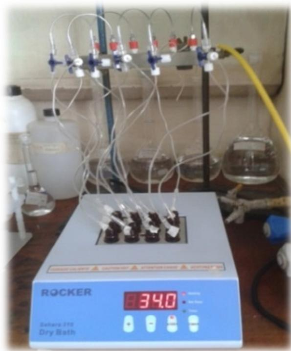
Figura 9: Mini Turbo Vap utilizado para el secado de los extractos, con corriente de N<sub>2</sub> a 35°C.
