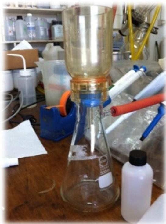
Figura 10: Celda de filtración con membrana para obtener la MOD.
