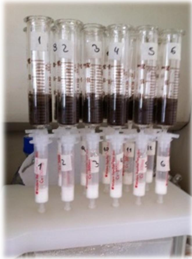
**Figura 12:** Columnas empacadas con suelos, conectadas a cartuchos de C18.
