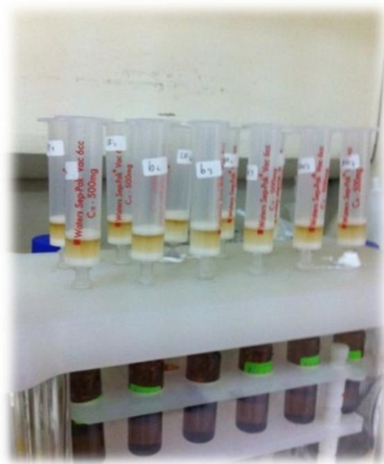
Figura 8: Manifold y cartridge utilizados en el proceso de SPE.
