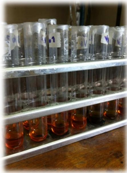
Figura 6: Tubos luego de la digestión ácida de las muestras para la determinación de CO.
