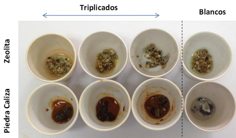
Figura 4.17: Medio remanente luego de la agitación, se tiene zeolita en la fila superior y piedra caliza en la inferior, con  $C = 0,2 \text{ mg/L}$ ,  $T = 18 \text{ h}$ ,  $M = 1,5 \text{ g}$  y  $[Fe] = 50 \text{ mg/L}$ .
