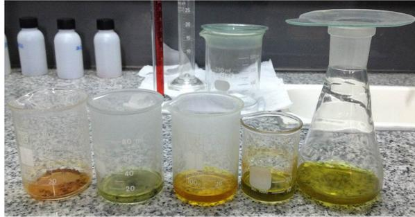
Figura 3.7: Digestiones zeolita y piedra caliza.
