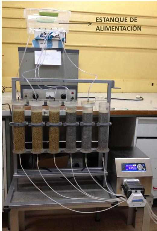
Figura 3.4: Montaje de columnas, estanque de alimentación y bomba de control de flujo.
