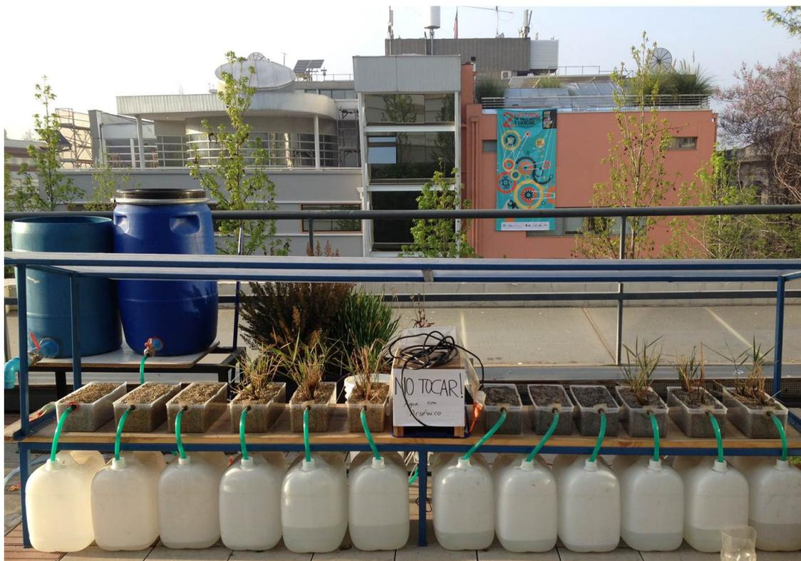
Figura 3.5: Humedales artificiales. De izquierda a derecha: 3 humedales de zeolita sin plantas, 3 con plantas y luego lo mismo para piedra caliza.
