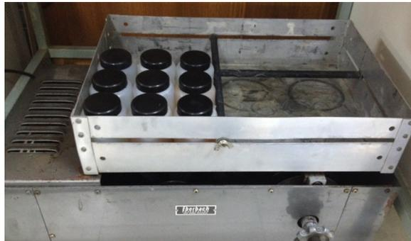
Figura 3.3: Agitador mecánico marca Eberbach y reactores *batch*.
