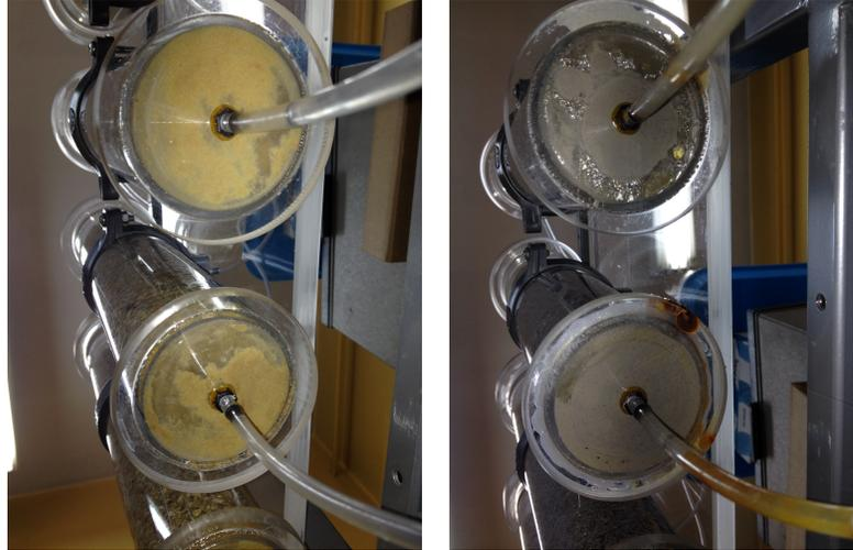
Figura 4.27: Transporte de finos hacia el fondo de las columnas de zeolita (izquierda) y piedra caliza (derecha).
