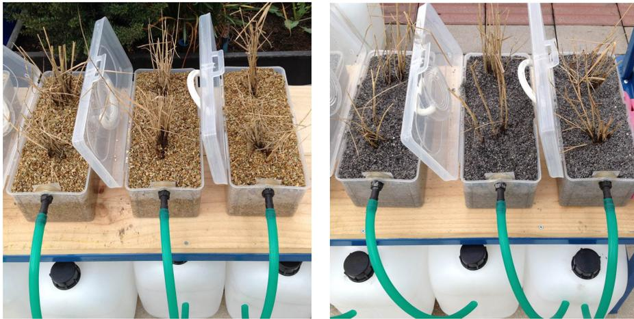
Figura 3.6: Humedales artificiales construidos con zeolita (izquierda) y piedra caliza (derecha).
