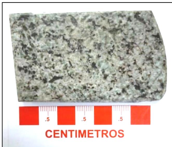
Figura 21. Granodiorita Río Blanco del sondaje 4853 / tramo167,5.
