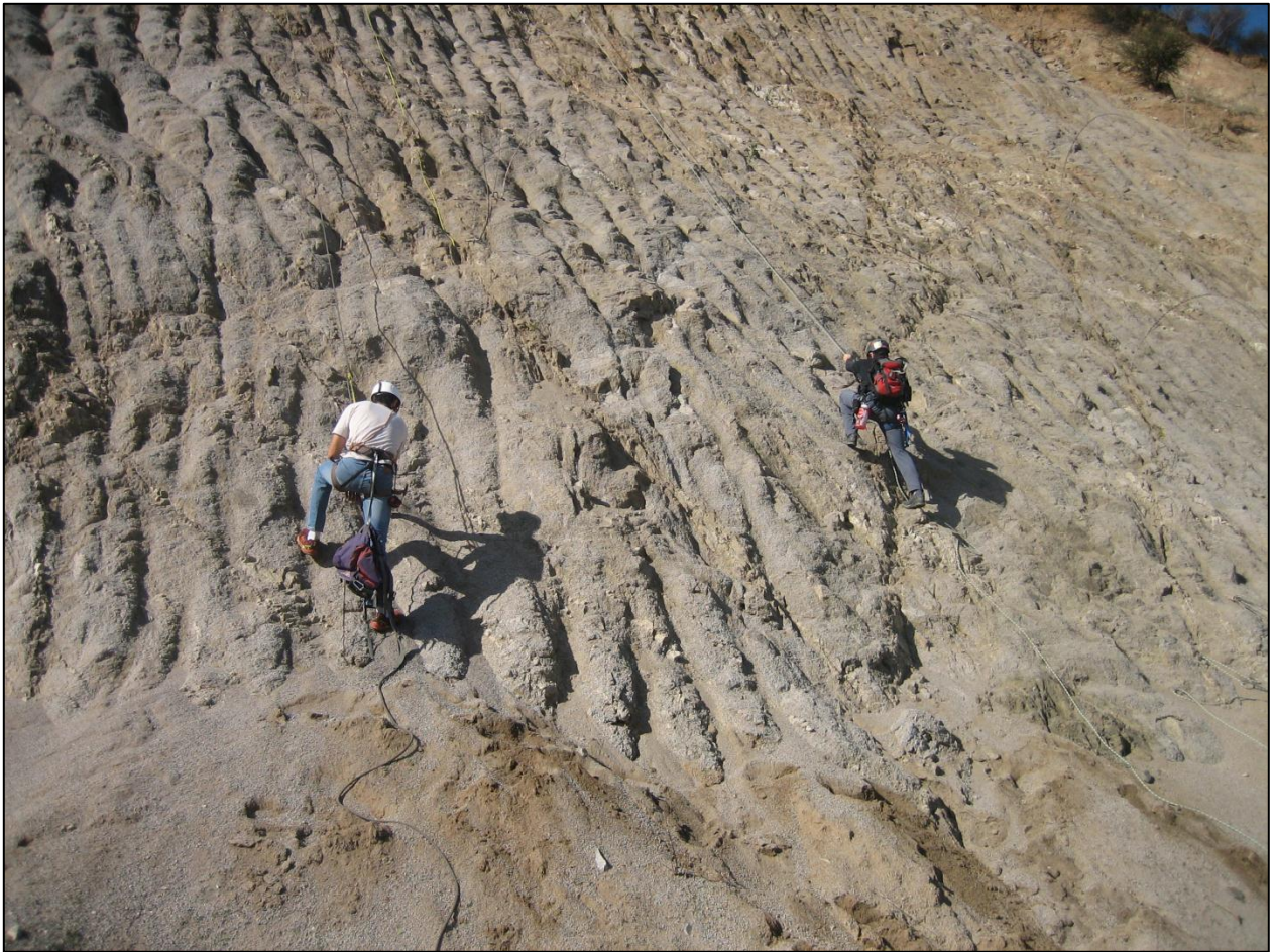
Figura 6: Foto que ilustra el método utilizado para recolectar las muestras en el perfil de regolito.
