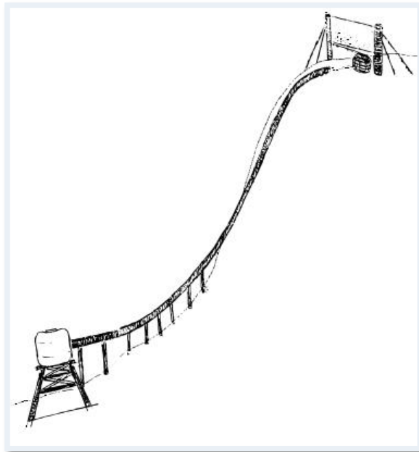
Figura 2: Representación sistema de colección de agua mediante atrapanieblas
