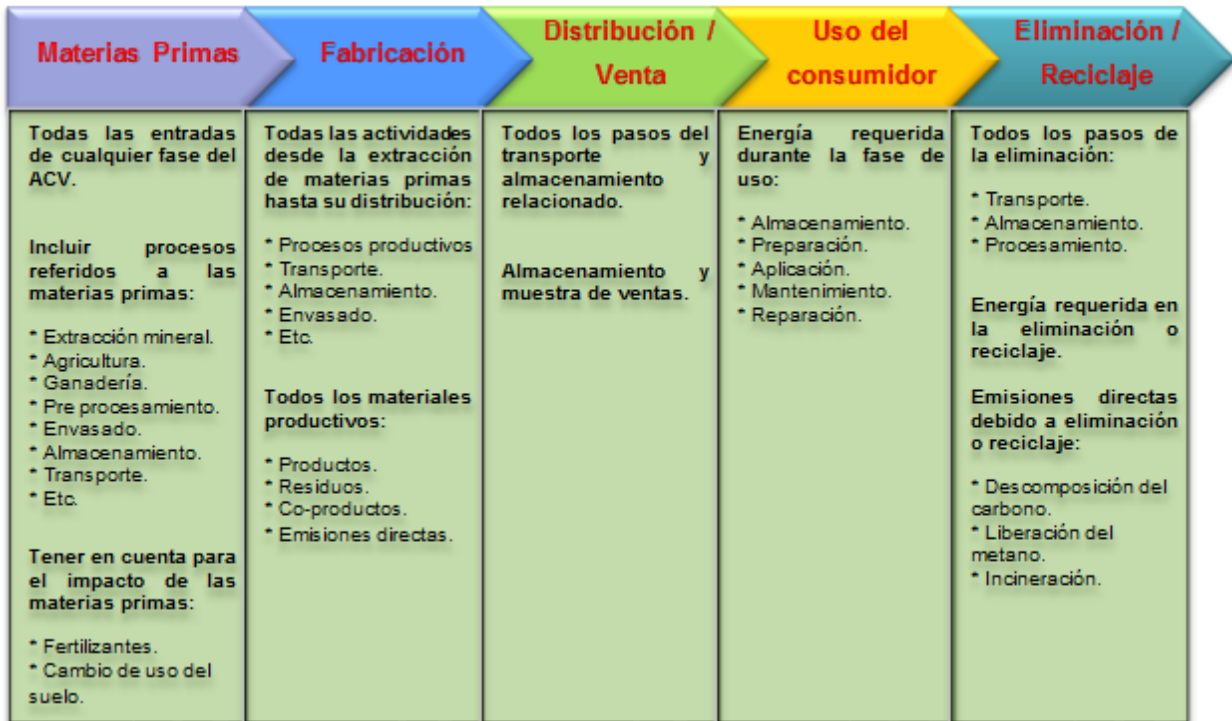
Figura 14 – Materiales/Actividades comunes a incluir dentro de los límites del ciclo de vida de un producto.
