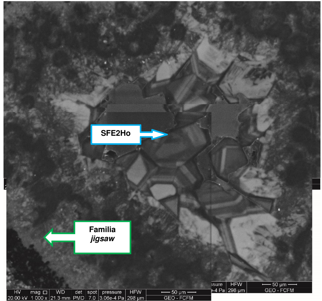
Figura A57: Rectángulo morado. Las familias reconocidas, de la pared hacia el centro, son: jigsaw y euهدral 2 con zonación homogénea (SFE2Ho).
