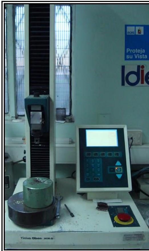
**Figura N° 11:** Máquina de Ensayos Universal
