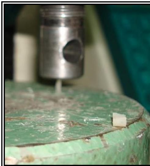
**Figura N° 14:** Probeta en el momento de su fractura tras la aplicación de una fuerza de compresión.
