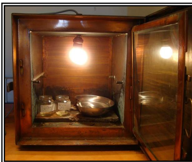
**Figura N° 10:** Estufa Tipo Heraeus con cuerpos de prueba en su interior.
