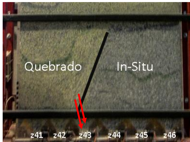
Figura 4-6: Entrada de material quebrado en puntos de extracción
