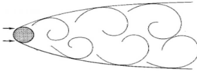
Ilustración 2.1: Vórtices que se forman producto del choque del viento con el conductor.
