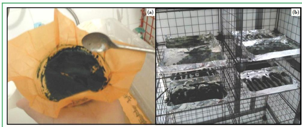
**Figura 8:** Procedimiento de cosecha de *Arthrospira platensis* (a) Biomasa al pasar por los filtros; (b) Biomasa en bandejas al interior del secador.
