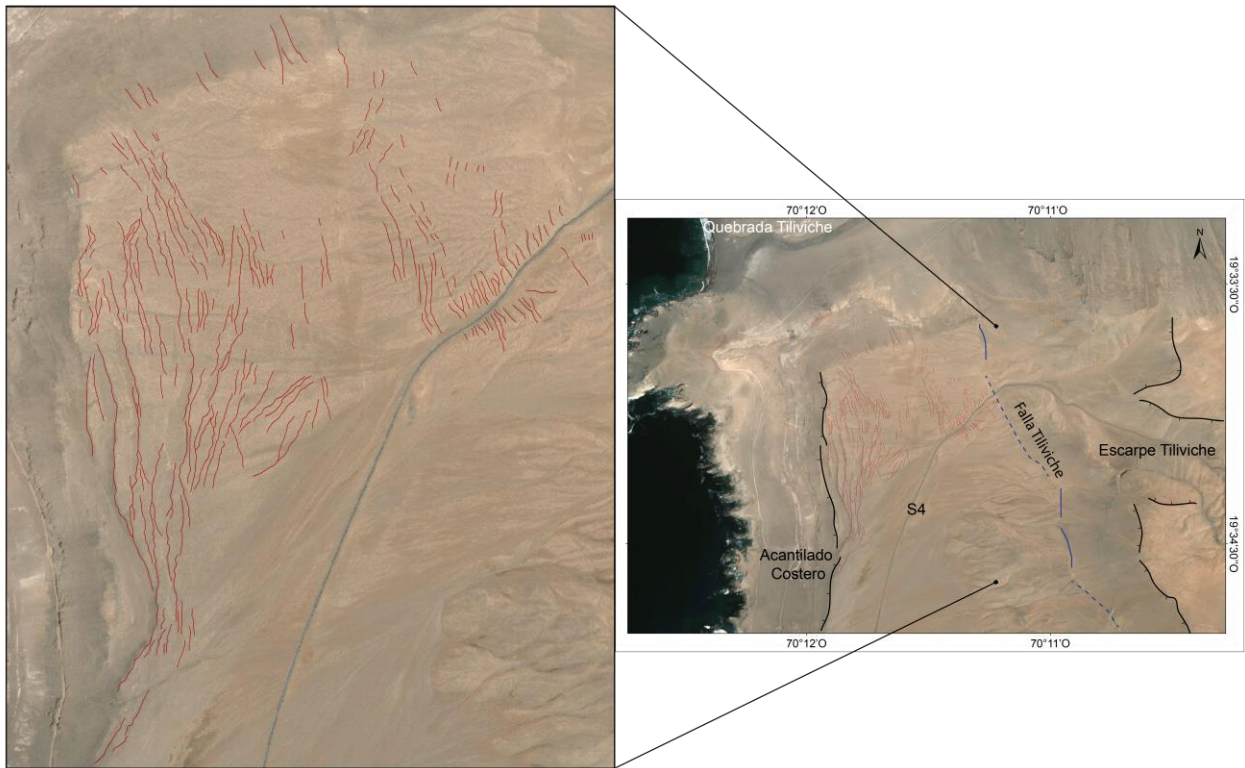
Figura 34.- Grietas cartografiadas en el pedimento S4, en el bloque inferior de la Falla Tiliviche. Se observa la ubicación de estas grietas, paralelas al escarpe Tiliviche y al Acantilado Costero, a la izquierda el zoom de las grietas.
