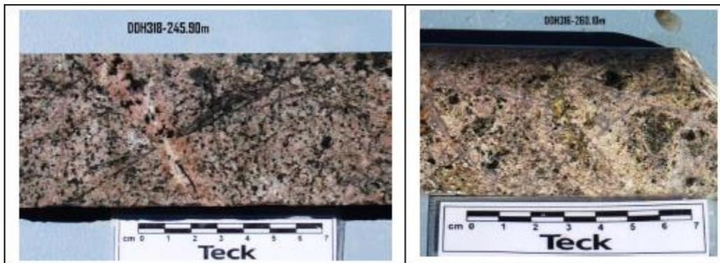
Figura 8: La imagen de la izquierda corresponde a una muestra macroscópica de cuarzomonzonita con una intensa alteración de feldespato potásico. La imagen de la derecha corresponde a una brecha hidrotermal con matriz de feldespato potásico, los clastos también cuentan una alteración de feldespato potásico de intensidad intermedia.
