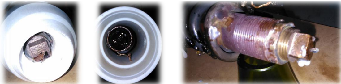
Figura 3-5. Calefactor Heredado Post Prueba
