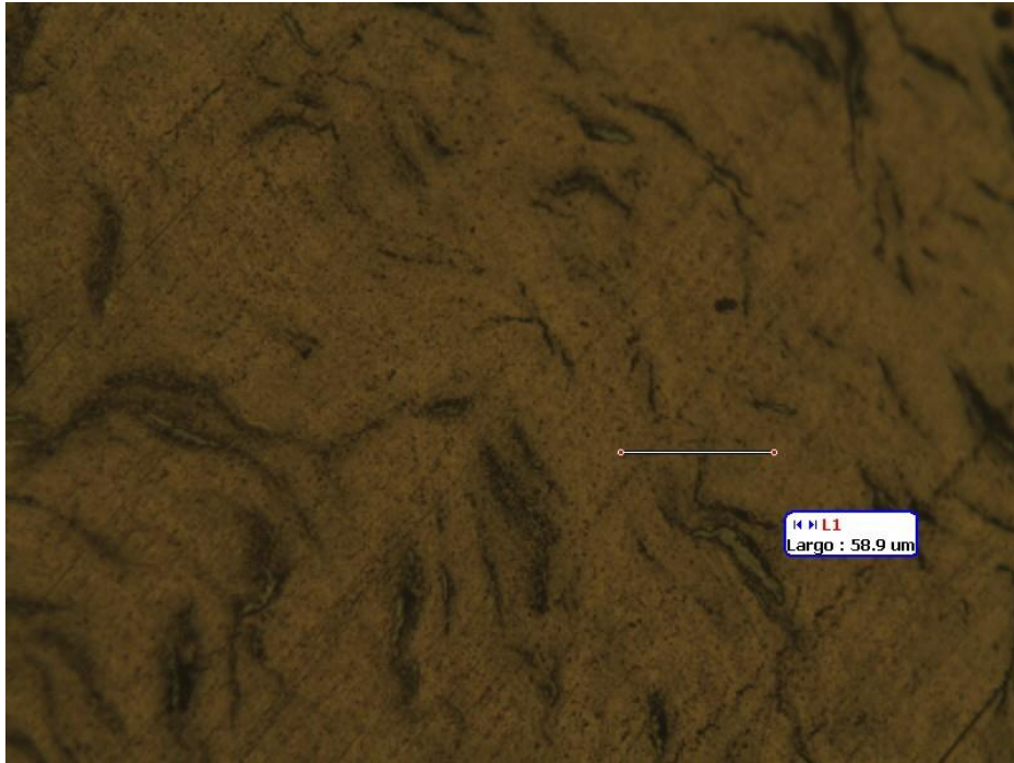
Ilustración 76: Micrografía óptica - Cu-5Ti - Tolueno - 10H - 200X.
