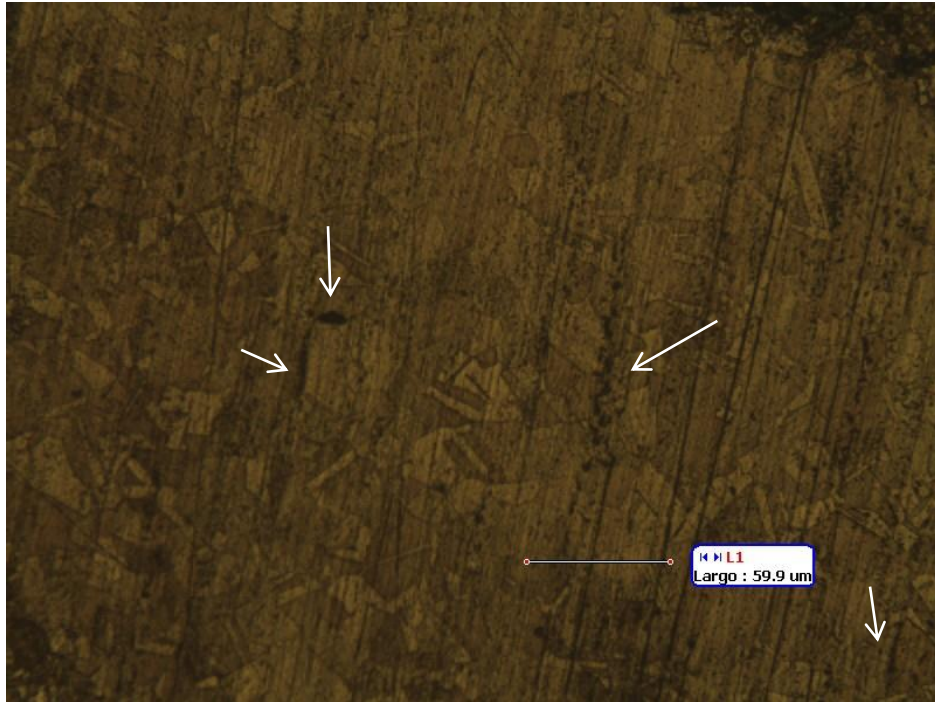
Ilustración 80: Micrografía óptica - Cu-5Ti - Carbono/Metanol - 10H - 200X.
