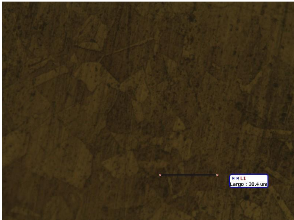
Ilustración 81: Micrografía óptica - Cu-5Ti - Carbono/Metanol - 10H - 400X.
