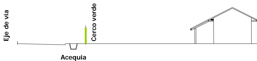
Figura 34: Ejemplo de emplazamiento de vivienda en Calle Los Cañones de Zona Típica Entorno de la casa patronal y otras dependencias de la Hacienda San José del Carmen, El Huique. Fuente: Consejo de Monumentos Nacionales (2011). Criterios y lineamientos técnicos para las obras de reconstrucción, y reparación de inmuebles en la Zona Típica "Entorno de la casa Patronal y otras dependencias de la Hacienda San José del Carmen el Huique "declarada por Decreto Exento N° 488 de fecha 29/08/1996. Publicado en el Diario Oficial el 20/09/1996. Comuna de Palmilla, Región del Libertador Bernardo O'Higgins.
