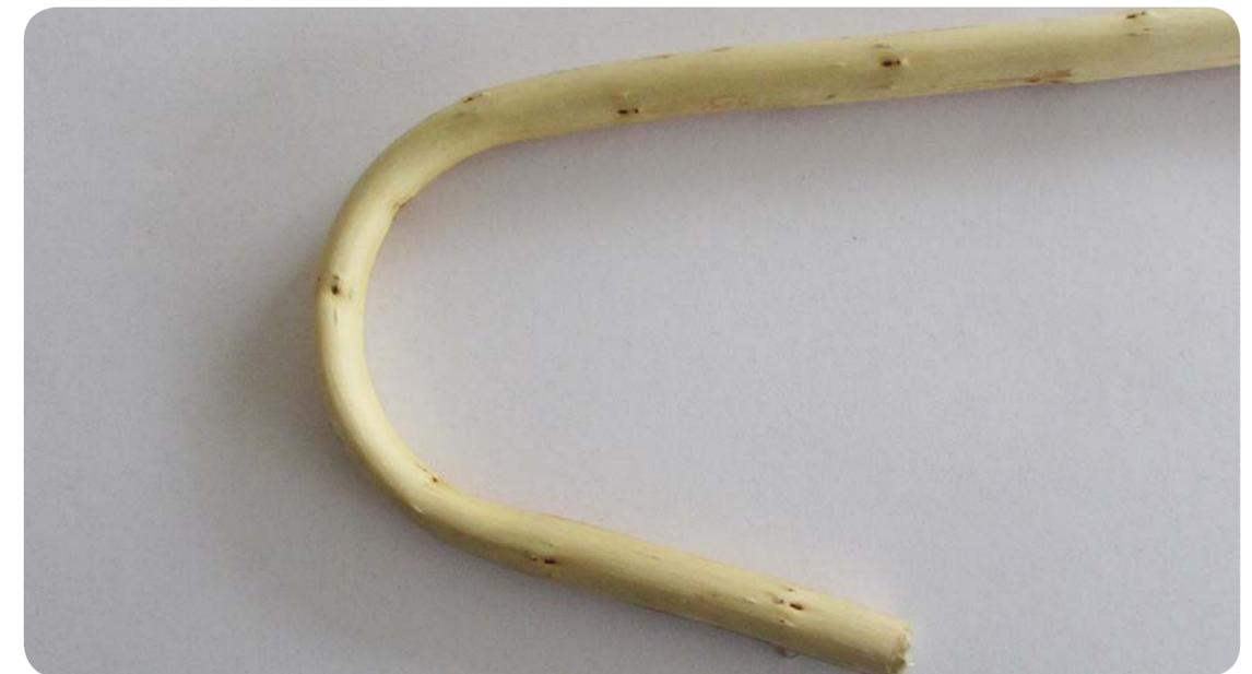
Imagen 64. Probeta con relación 1 es a 6. Elaboración propia.
