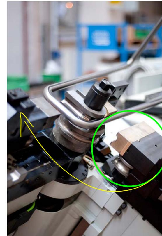
Imagen 37. Dobladora CNC. fuente: <http://dobladorasyroladoras.com/>
