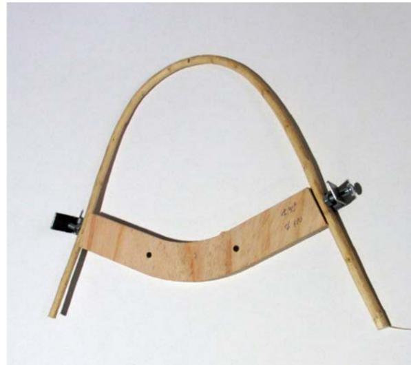
Imagen 106. Probeta diámetro 180mm, ángulo 45. Elaboración propia.
