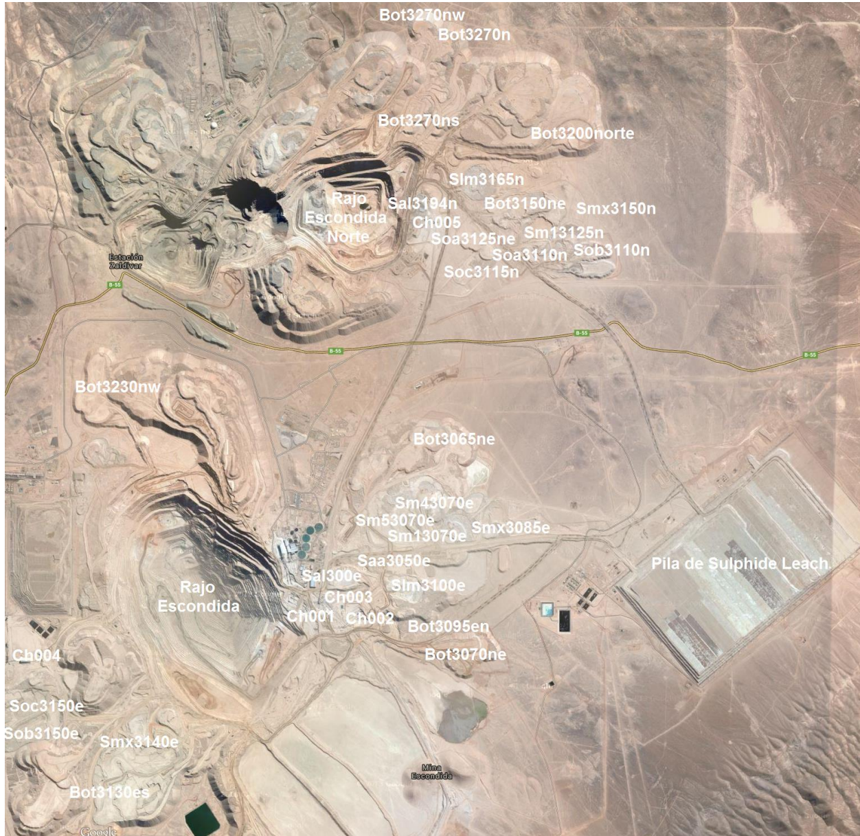
Ilustración 3: Layout del sistema de carguío y trasporte en Minera Escondida.
