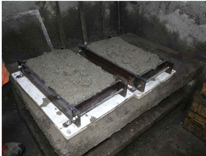
Figura III-9. Molde relleno de hormigón antes del vibrado.
