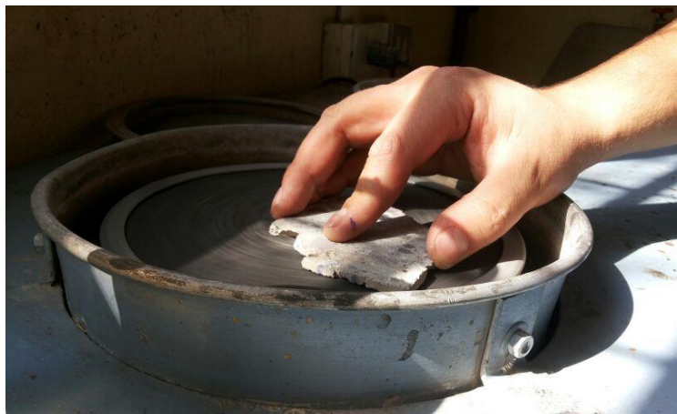
Figura III-23. Pulido de las muestras.
