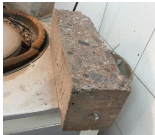
Figura III-17. Probeta obtenida del aserrado de la loseta.
