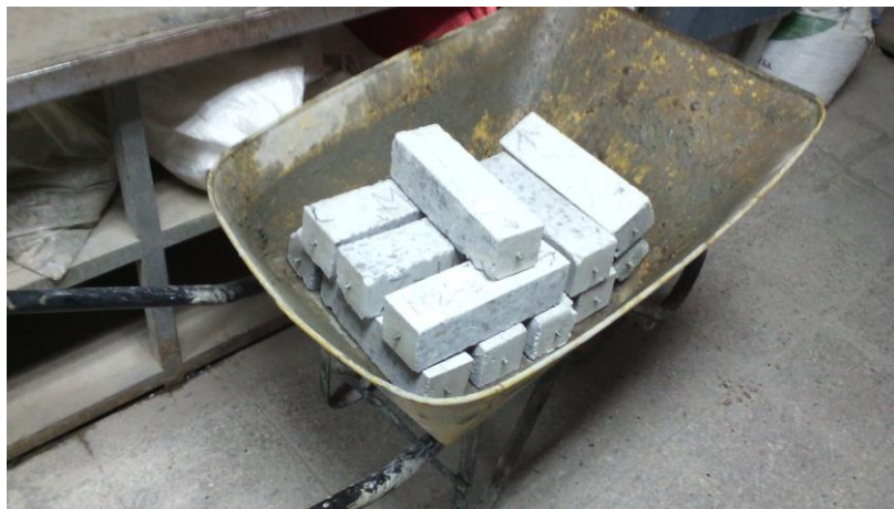
Figura III-20. Probetas después del secado en horno durante 1 día.
