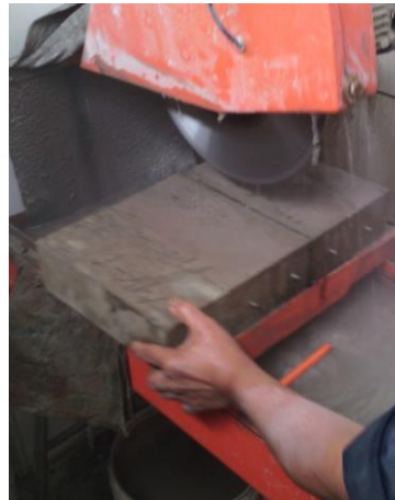
Figura III-16. Aserrado de la loseta que se realiza a las 24 h después de la confección del hormigón.
