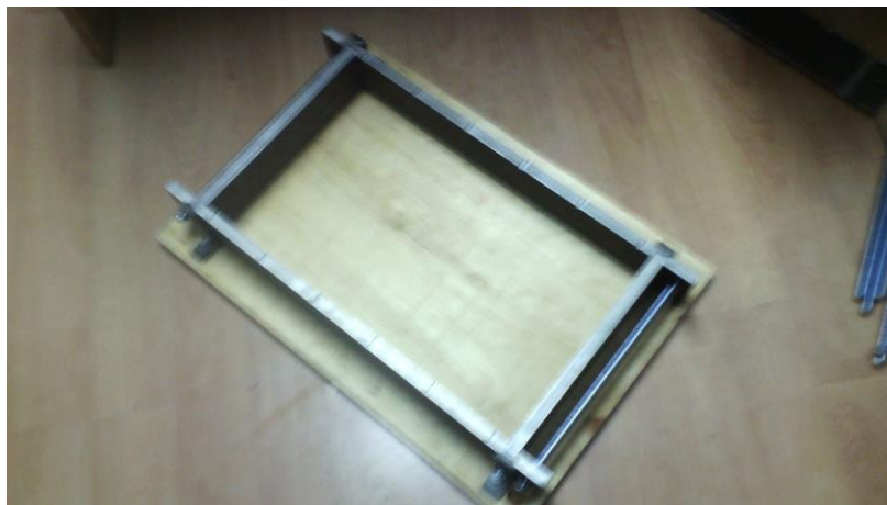
Figura III-7. Vista superior molde de la loseta de hormigón.
