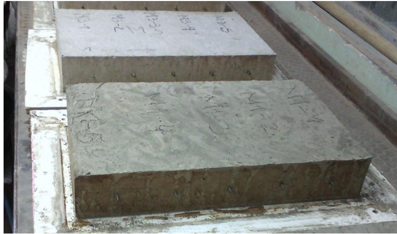
Figura III-15. Losetas después de ser desmoldadas. La loseta de la parte superior de la imagen fue curada aceleradamente.
