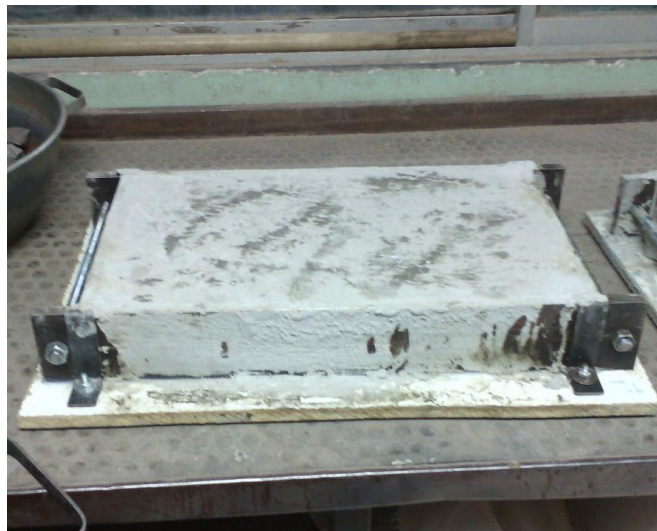
Figura III-14. Loseta curada de forma acelerada antes de ser desmoldada.
