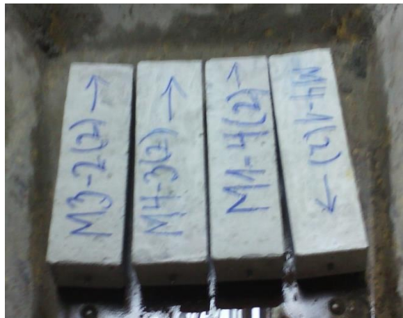
Figura III-21. Probetas después del humedecimiento durante 1 día.
