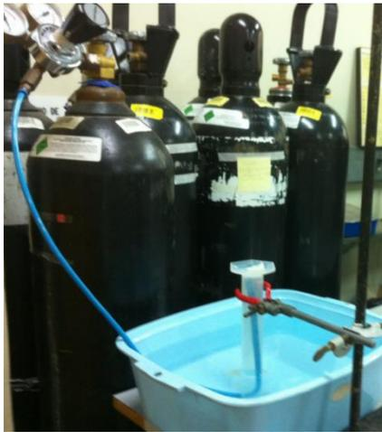
**Figura 26: Montaje experimental de la probeta invertida.**
