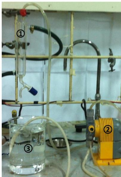
Figura 23: Montaje para la determinación del flujo para cada relación corteza-cuarzo. 1) Columna de vidrio con un diámetro de 2,5 [cm] y una altura de 18,0 [cm], 2) Bomba peristáltica, 3) Vaso precipitado de 2 [l].
