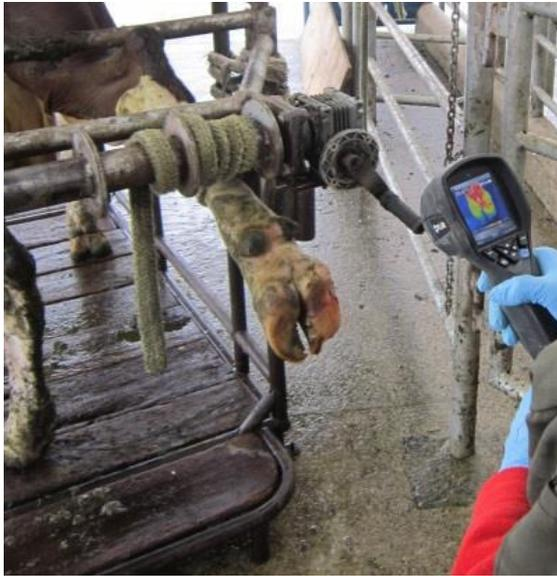
Figura 1. Toma de imagen termográfica de la zona de la suela (vista solear).
