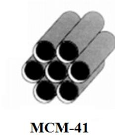
**Figura 1.26.** Estructura de sílice mesoporosa MCM-41<sup>135</sup>.
