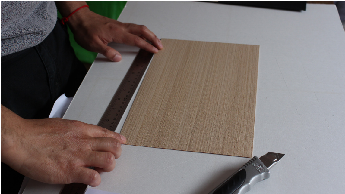
[141] Fotografía de proceso, recorte de chapa de madera de coihue, 2015.
