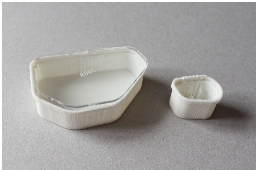
[121] Pruebas impresión 3D PLA y acrílico de 2mm cortado y grabado en láser, 2015.
