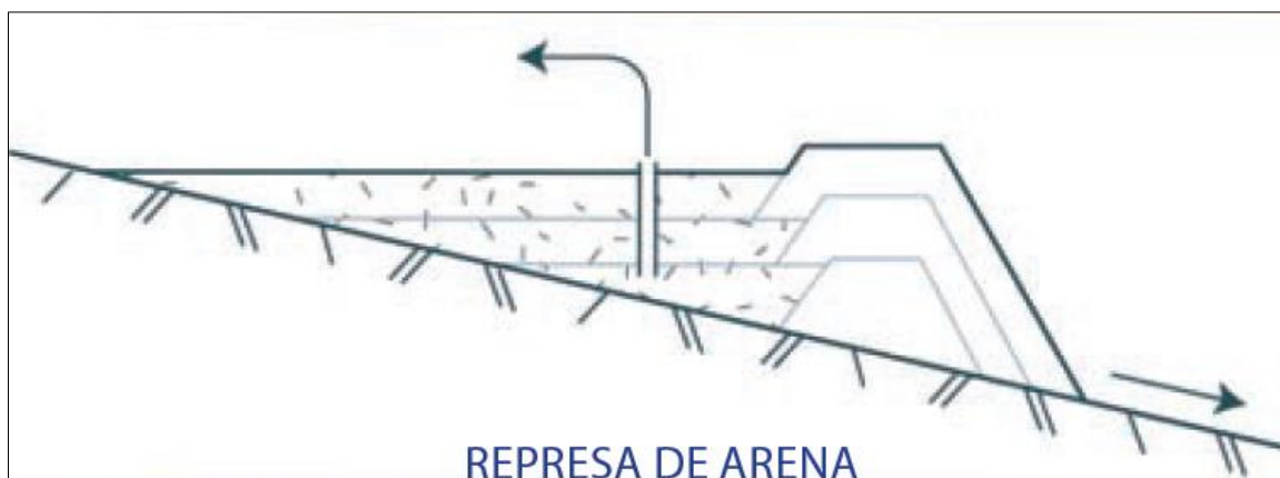
Figura B.3: Representación esquemática de un sistema de represa de arena. Fuente: Imagen extraída de UNESCO, 2005.
