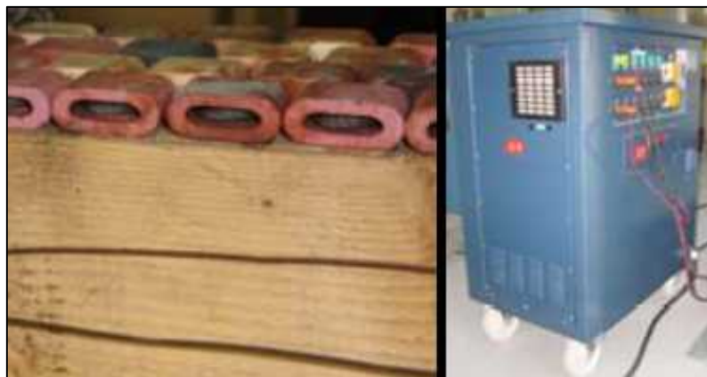
Figura 3.12 “Sistema electro-cerámico de calentamiento ( Izquierda ); Unidad Térmica ( Derecha ), Fonseca y Barreira (2009)”
