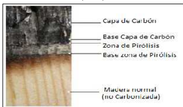
Figura 2.1 “Zonas durante carbonización en una sección de madera, Fonseca y Barreira (2009)”
