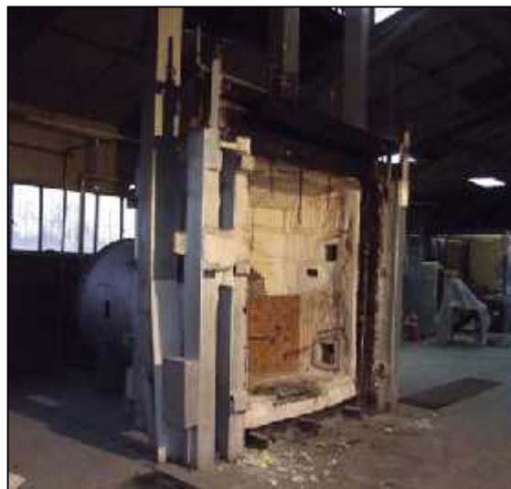
Figura 5.3 “Horno vertical laboratorio de incendios IDIEM”.
