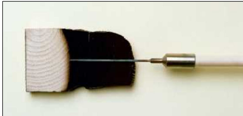
Figura 3.10 “Principio de la medición continua de la carbonización, Ligens (2003)”
