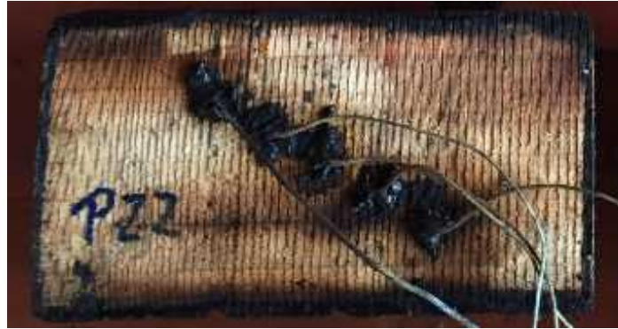
Figura 6.1 “Sello y fijación de termocuplas post-ensayo”
