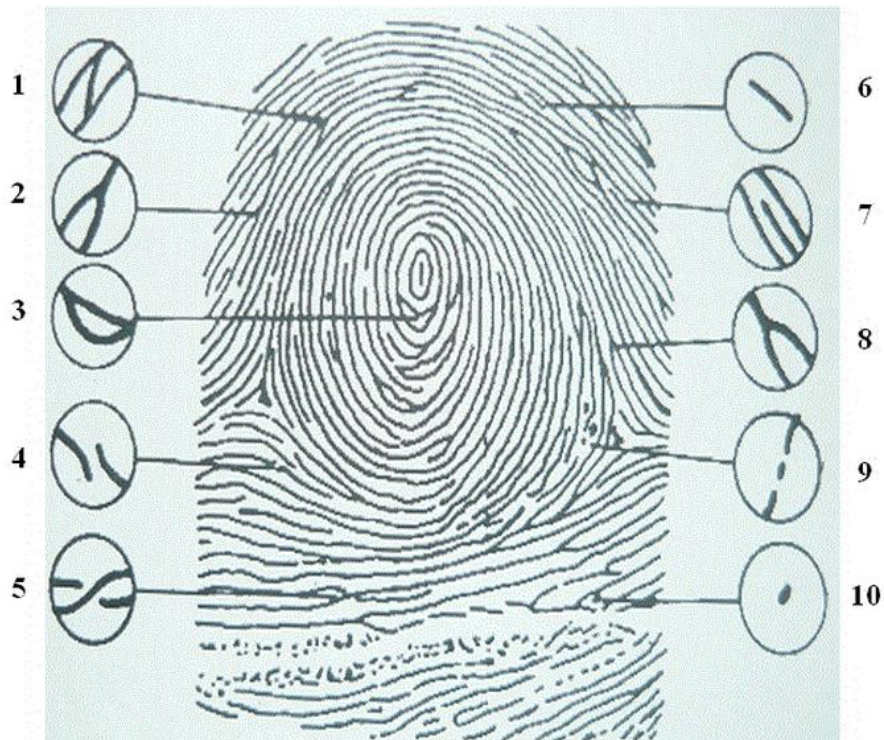
Figura 6. Algunos tipos de minucias: 1 empalme o cruce, 2 convergencia, 3 laguna u ojal, 4 desviación, 5 transversal, 6 fragmento o borde independiente, 7 abrupta o terminación, 8 bifurcación, 9 interrupción, 10 punto o isla. Imagen tomada de [3].
