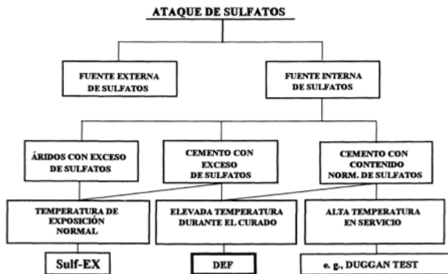
Figura 2-2: Esquema de posibles ataques internos de sulfatos en el hormigón. [12] 15
