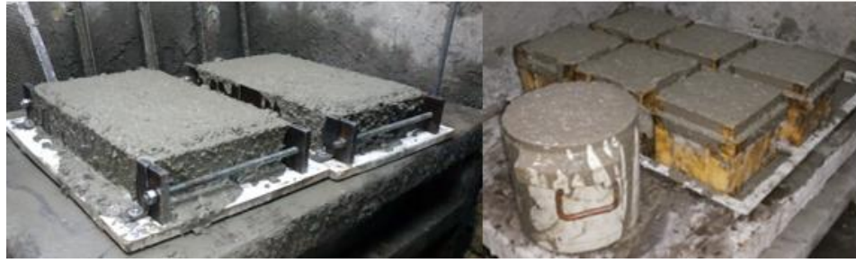
Figura 4-11: Pastelones y Cubos Vibrados. [28]
