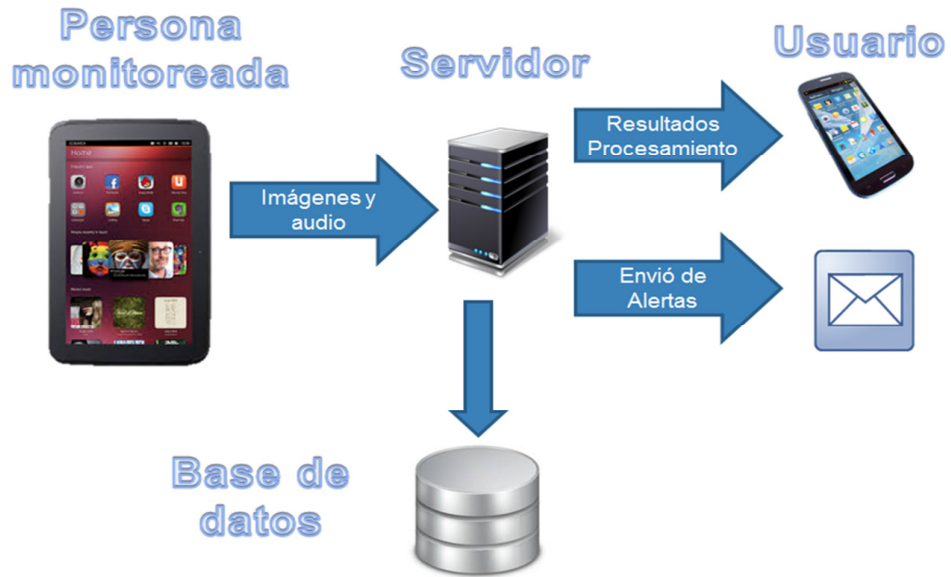
FIGURA 7 Arquitectura física de la solución
