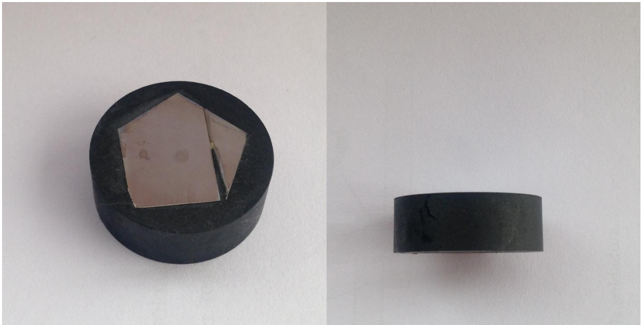
Figura 4.21 Placa soldada en molde de baquelita
