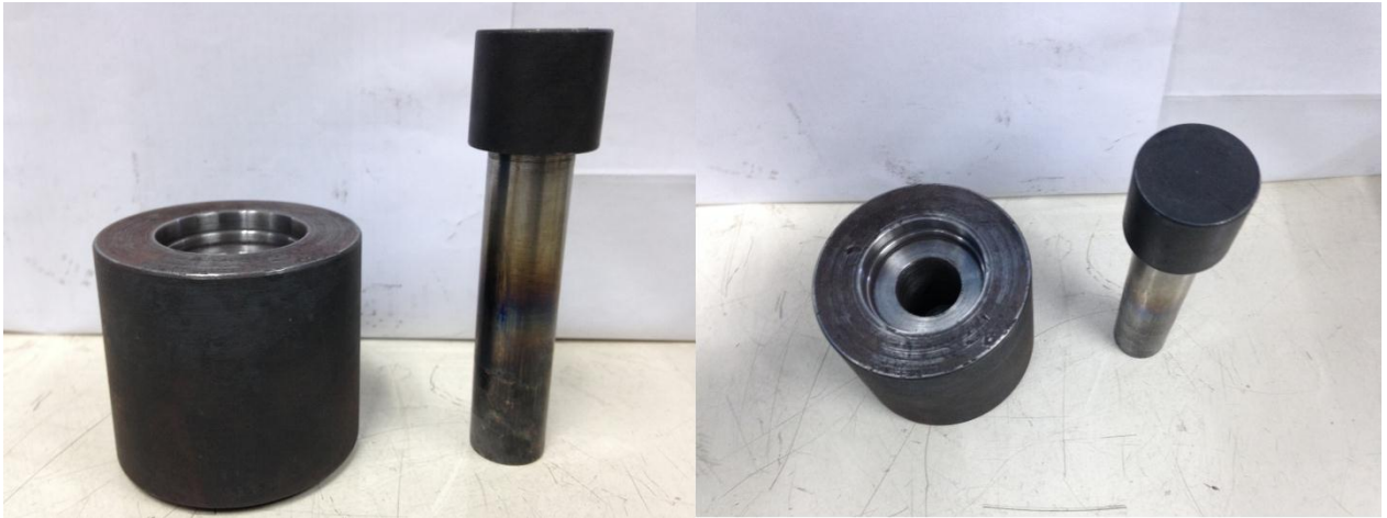
Figura 3.6 Matriz y punzón utilizados para la extrusión
