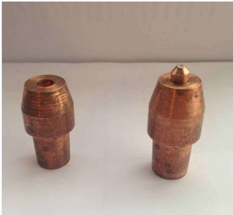
Figura 3.9 Porta Electrodo con y sin electrodo montado
