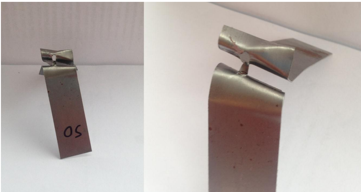
Figura 3.11 Fotos del análisis de desprendimiento
