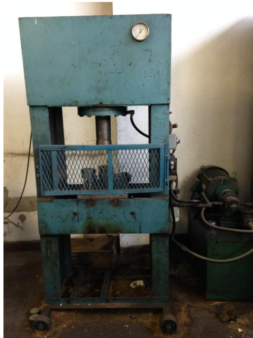
Figura 3.7 Prensa utilizada para la extrusión en caliente
