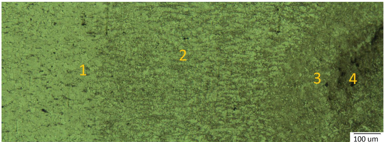
Figura 4.23 Visión microscópica del punto de soldadura con zoom 100x
