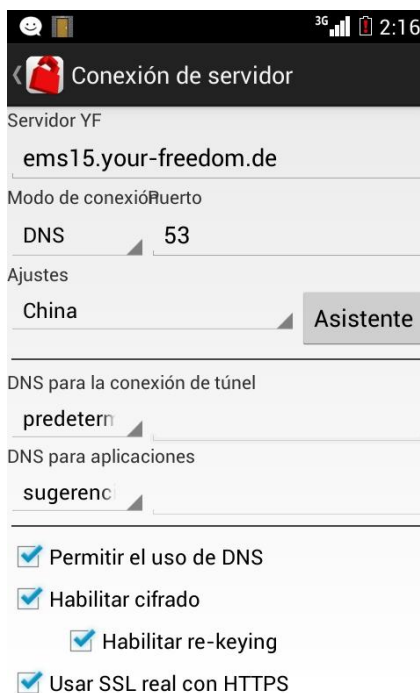
Figura 28: Configuración de YourFreedom para navegar gratis sobre el protocolo DNS.
