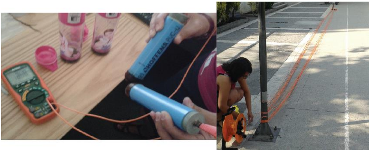
Figura 3.7: Izq) Prueba de conductividad entre electrodos en el laboratorio. Der) Midiendo el cable conductor que se ocupó en terreno.
