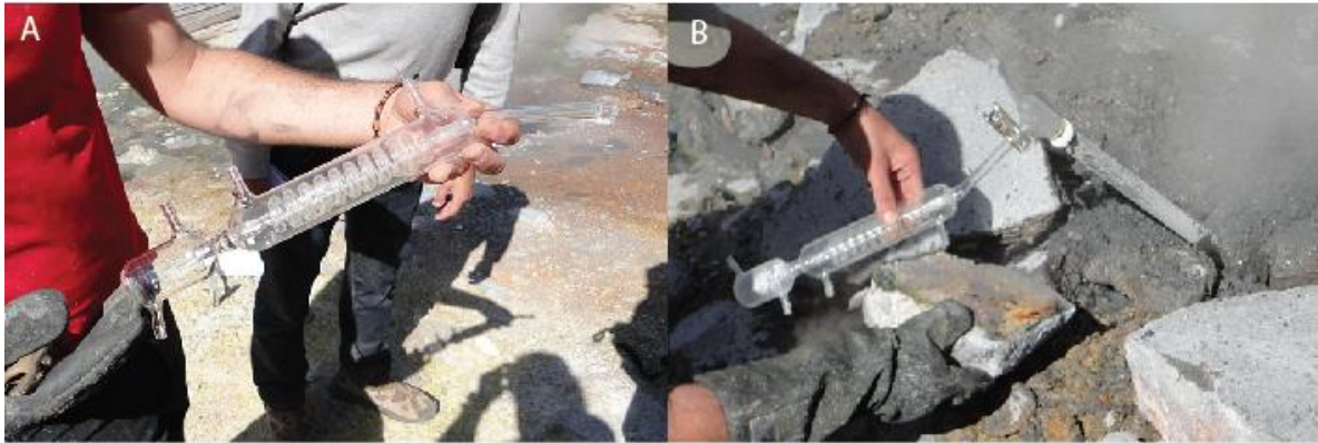
Figura 3.3: Muestreo de fumarola en Las Maquinas; A) Muestra el condensador junto al tubo de pyrex y el separador de doble salida. B) Muestra la conexión del condensador con el tubo de titanio que está enterrado en la fumarola.
