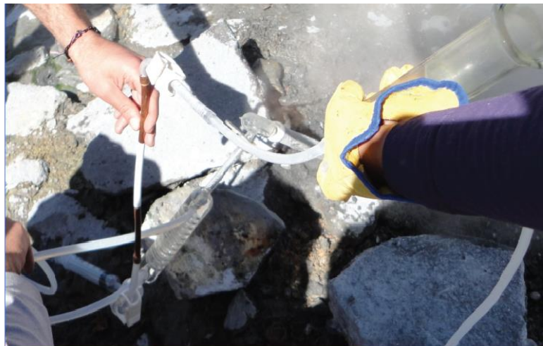
Figura 3.4: Izq) Esquema del montaje para la toma de muestra en fumarolas de alta temperatura. Der) Fotografía de la toma de muestra con tubo de cobre, se pueden observar las pinzas plásticas en el tubo de silicona y el bombeo manual de la muestra con la jeringa.
