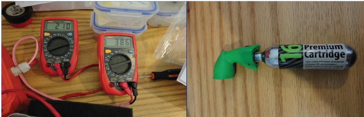
Figura 3.10: Izq) Muestra la medición de la saturación del espectrómetro de 3000ppm (voltaje 386 mV) y el voltaje correspondiente en el espectrómetro de 10% al realizar la calibración. Der) muestra el cartridge de CO 2 puro utilizado para realizar la calibración.
