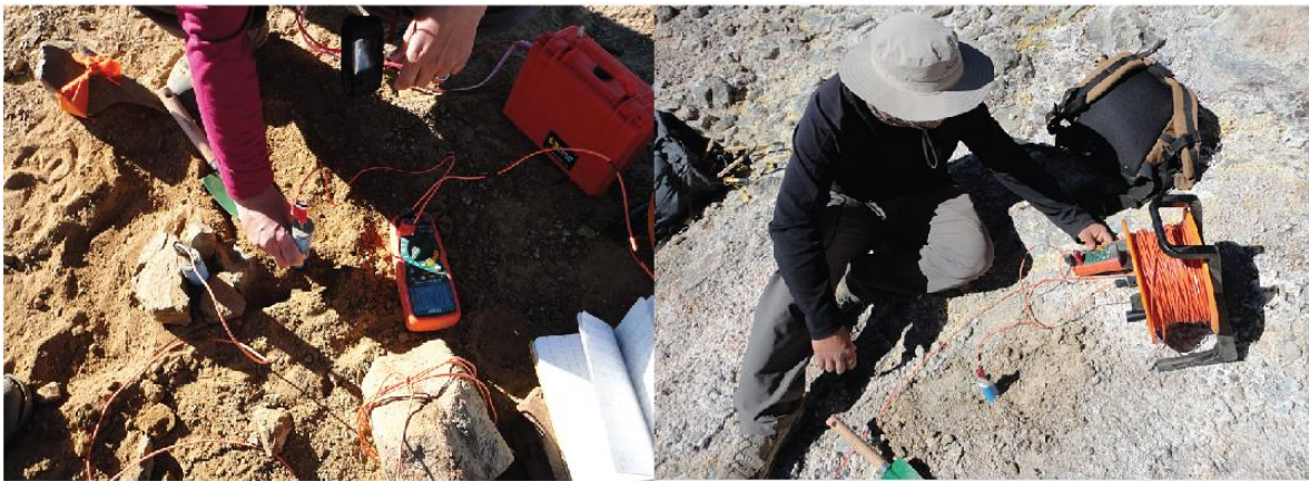
Figura 3.8: Izq) Muestra la medición de la resistencia en el punto de referencia, notar como el electrodo fijo se encuentra sujetado con rocas alrededor y como se mide la conductividad y voltaje a una distancia pequeña (10 cm aprox.) Der) Muestra la medición del potencial espontaneo con el electrodo móvil.
