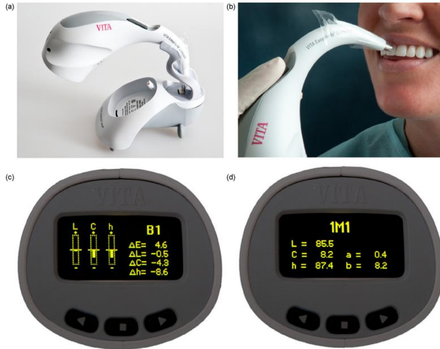
Figura 4: Aplicación clínica del espectrofotómetro EasyShade Compact. (a): Calibración del instrumento. (b) Medición del color dental. (c) Diferentes valores métricos correspondientes a la escala Vitapan Classical. (d) Valores de las coordenadas del color y su valor correspondiente de la escala Vitapan 3D-Master (Chu y cols, 2010).
