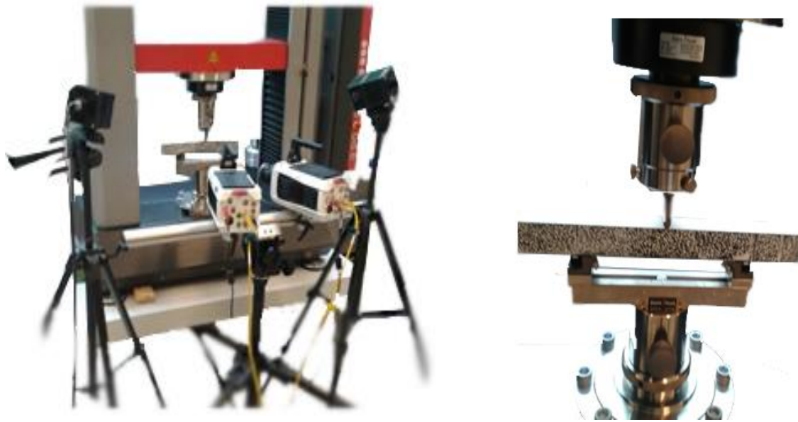
(a) Disposición espacial de las cámaras DIC (carcasa blanca) y focos de iluminación (carcasa negra).
