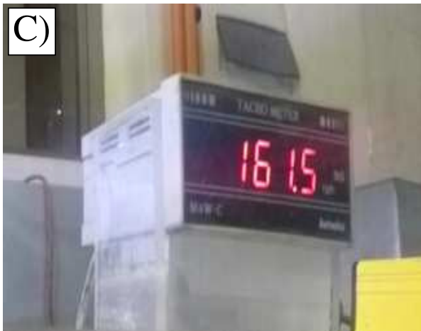
Figura 5.3: A) Acelerómetro ADXL345 Evaluation Board. Fuente: Sparkfun electronics. B) Probeta 2D del ADV Sontek. Fuente: SonTek C) Tacómetro Autonics. D) Vista general de la instalación.
