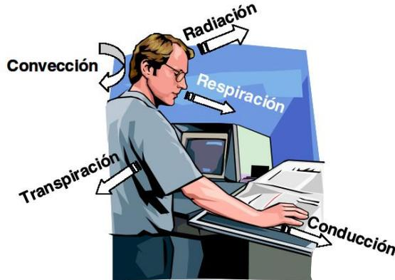
Figura 2.7 Transferencia de calor en el cuerpo humano. Fuente: Acondicionamiento térmico de edificios
