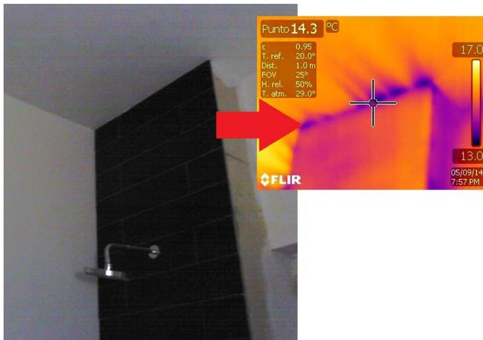
Figura 3.13 Infiltración a través del encuentro losa-tabique
