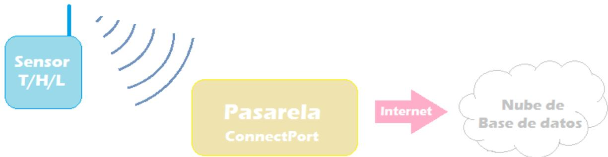
Figura 5.1 Esquema sistema de medición
