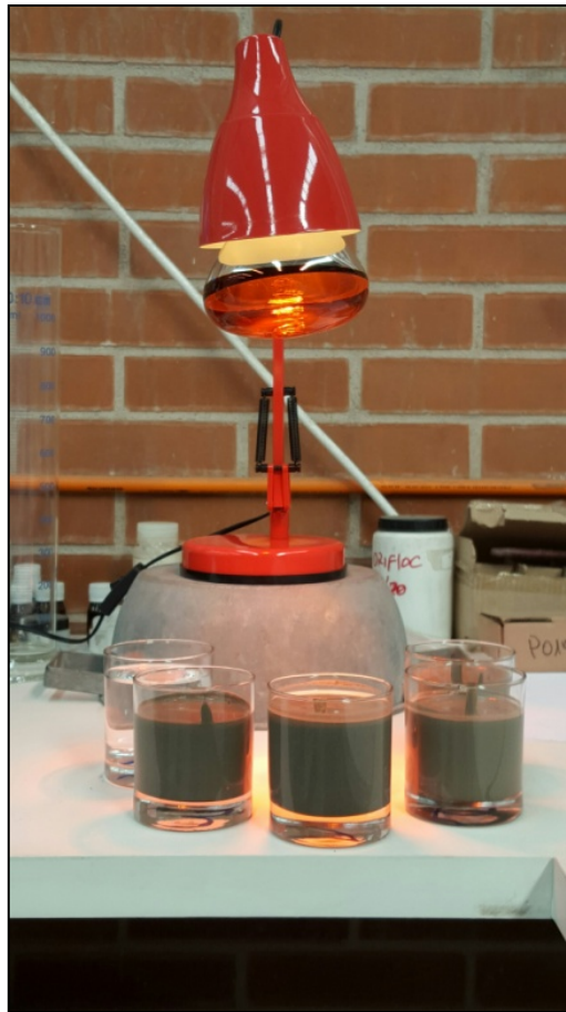
Figura 17: Montaje ensayo de evaporación.
