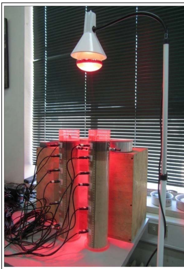
Figura 10: Ensayo de infiltración propuesto por Rivera (2012).
