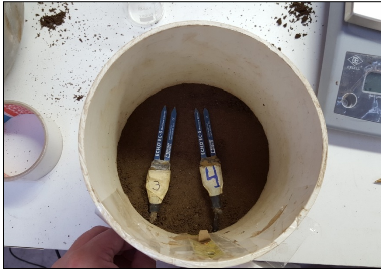
Figura 24: Calibración de sensores de humedad
