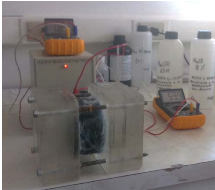
Ilustración 4.5 Montaje de ensayo ASTM C1202
