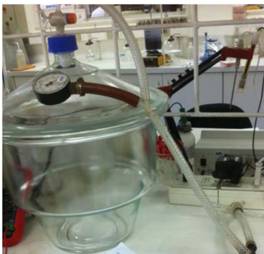
Ilustración 3.1 Cámara de secado y manómetro
