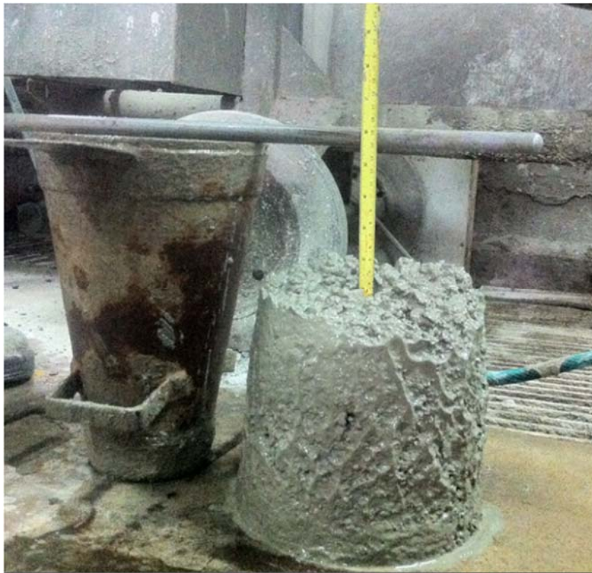
Ilustración 4.2 Ensayo de asentamiento de cono HC
