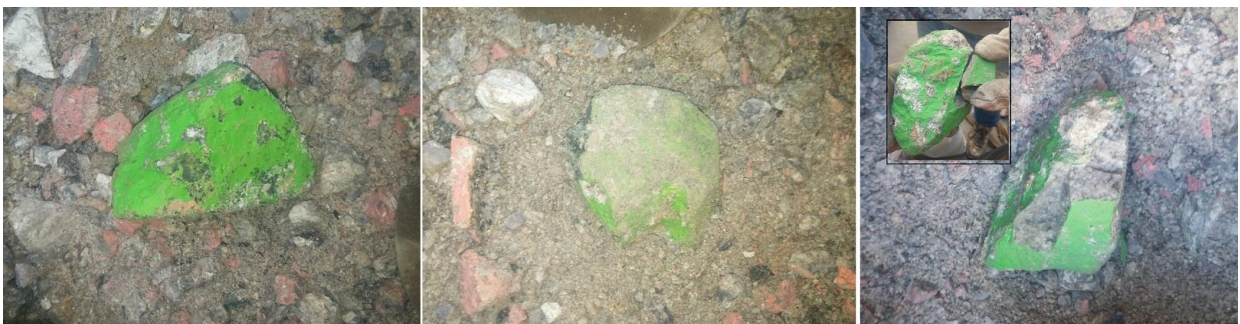
Figura 6-36. Partículas retenidas en 3" tras ensayo (zona superior)
