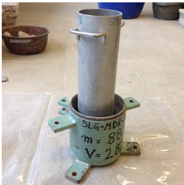
Figura 7-15. Embudo largo en molde de ensayos de densidad.
