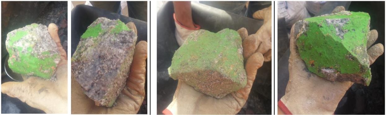
Figura 6-37. Partículas retenidas en 3" tras ensayo (zona inferior)
