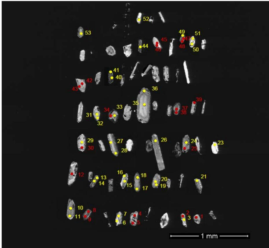
Figura 42: Puntos de ablación en la muestra CPIP01.
