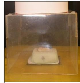
*Figura N°27: Estandarizador para toma radiográfica.*
