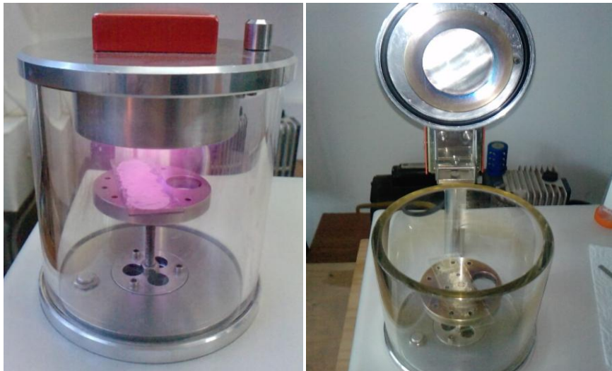
Figura 1.7: Fotografías del equipo de PC asistido por imanes. A la izquierda se observa el plasma producido durante la desintegración de la lámina. A la derecha se observa la cámara abierta, con la lámina metálica puesta en la sección catódica.
