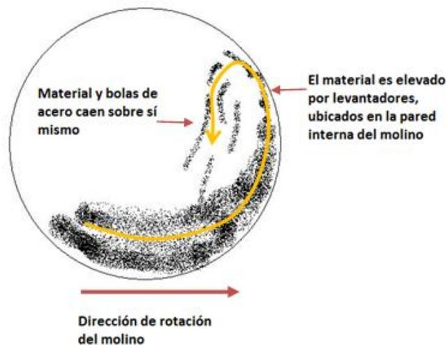
Figura 4.2 : Representación del proceso del molino SAG.
