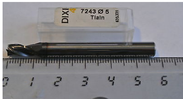
Figura 4.3: Ejemplo de fresa utilizada para mecanizar duraluminio. La broca mostrada posee un diámetro de 5 mm y el largo de esta es de 15 mm. En general la relación entre el diámetro y el largo de una fresa es de 1 : 3.
