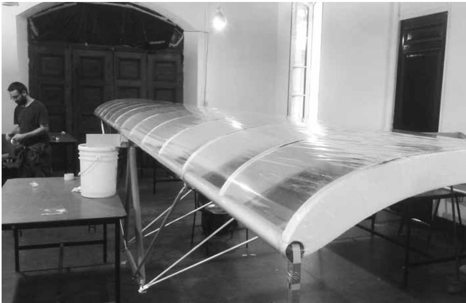
Figura 8: proceso de construcción del ala. Fuente: los autores.
