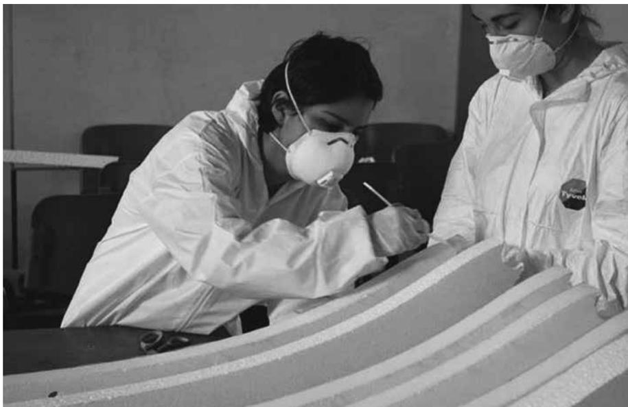
Figura 7: proceso de laminado de las costillas del ala. Fuente: los autores.
